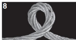
8 Toto lano se zkroutilo ve směru otevírání (odvíjení) ocelového lana. V nezatiženém stavu tvoří smyčku ve směru otáčení lana. Po zatížení lana se smyčka utáhne a může trvale změnit tvar lana.
