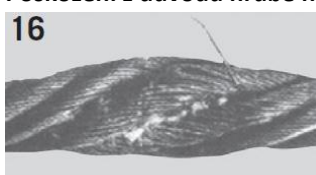
16 Zploštění z důvodu mačkání. Poškození jsou trvalá.
