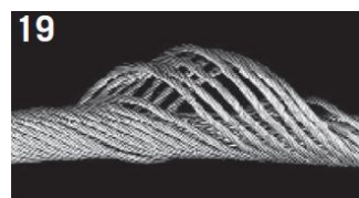
19 Vznik košíku na nekroutivém ocelovém laně. Pokud jste viděli jedno, viděli jste všechny.
