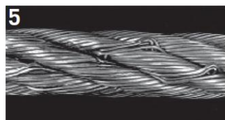
5 Na tomto šesti pramenném laně se kvůli kroucení povolily vnější vrstvy drátů
