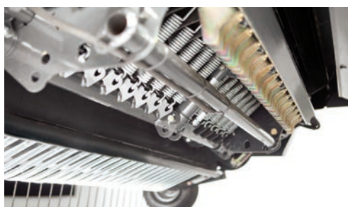
DROP-FLOOR (SPOUŠTĚCÍ DNO)
