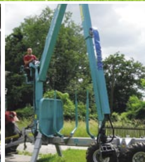
Vyššené stanoviště obsluhy – hydraulicky sklopné
