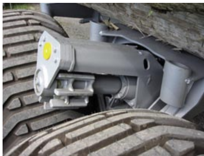
Trakční válečky s držákem, hydraulickým motorem a přítlačným pístem
