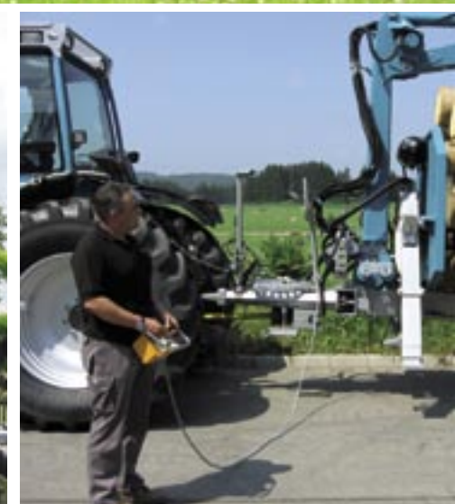
Ovládání Pfanzelt pomocí dvou joysticků – snadné přendání z kabiny do kabiny, možnost ovládání mimo traktor
