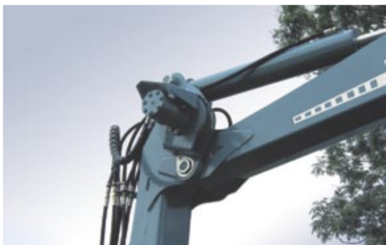
Hydraulický naviják se silou 1,5 t ovládaný vysílačkou
