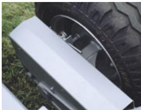
Přikrytí brzdného systému na boogie nápravě
