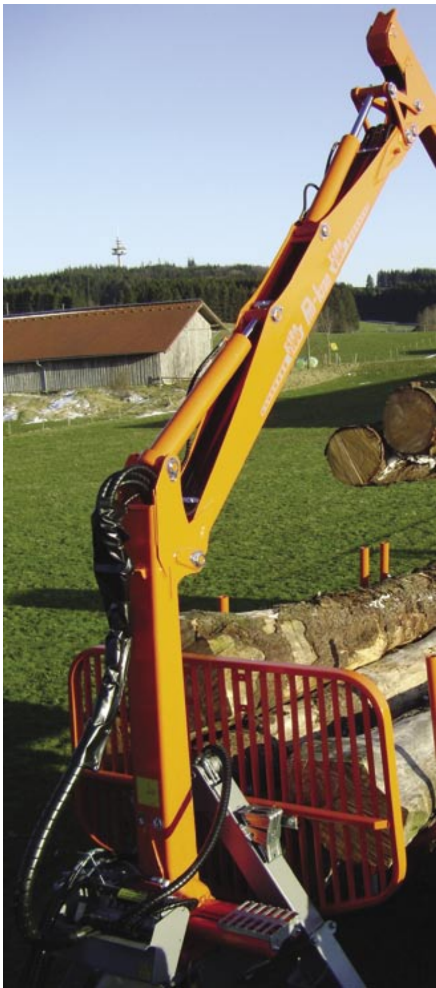
Dvojitý hřebenový pohon – s pouzdem otoče odlitého z jednoho kusu litiny
