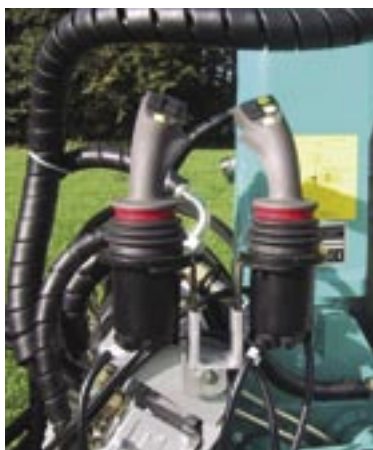
EHC – rozvaděč Danfoss s joysticky
