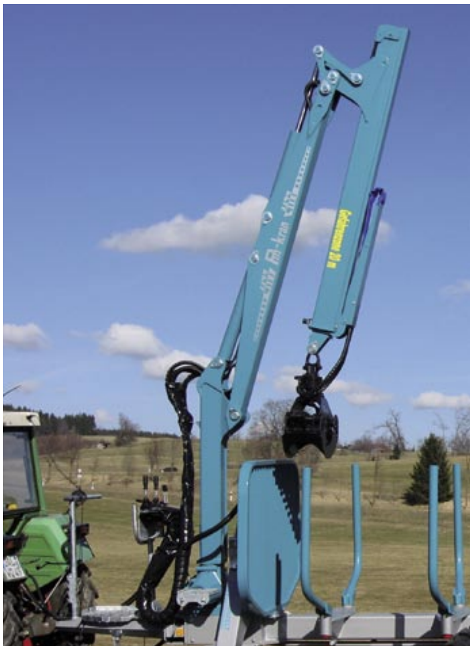
Hydraulické hadice chráněny po celé délce ramene
