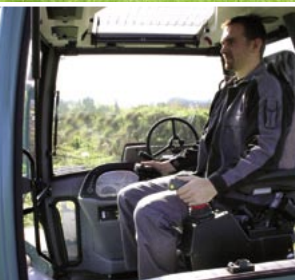
Ovládání hydraulického ramene z kabiny traktoru
