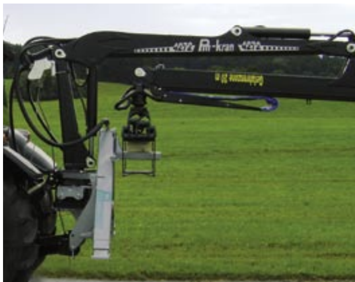
Hydraulické rameno PM 4272 uložené v tříbodovém závěsu traktoru
