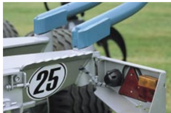
Integrované osvětlení vyvážecího vozu s mechanismem ochrany proti poškození
