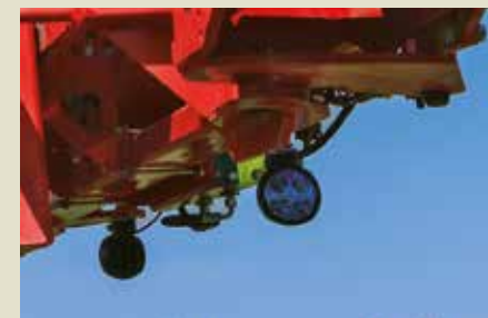
Pracovní osvětlení ramen (LED) Sledování ramen při práci po setmění
