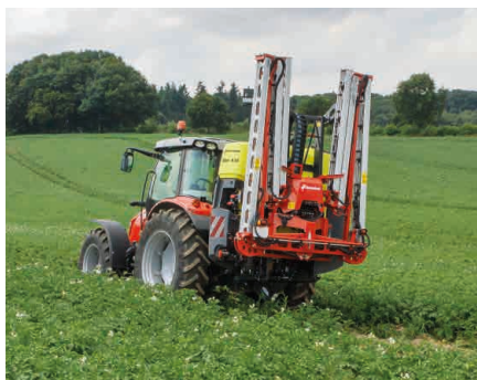
Variabilita skládání ramen - aplikace jen jednou stranou
