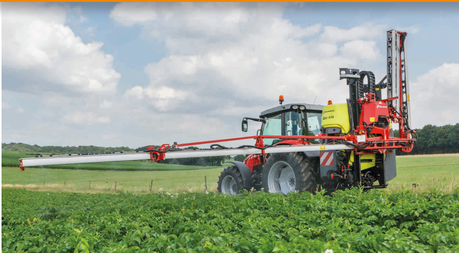
Variabilita skládání ramen - aplikace jen jednou stranou
