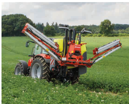
Variabilita skládání ramen - aplikace jen jednou stranou
